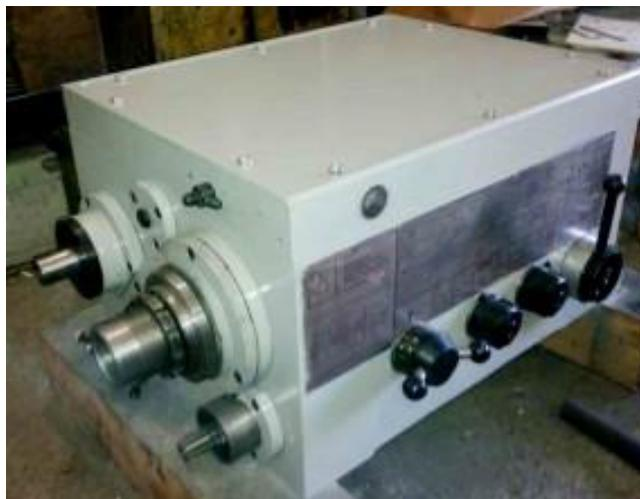
Рисунок 2 – Передняя бабка отдельно от станка [5]
